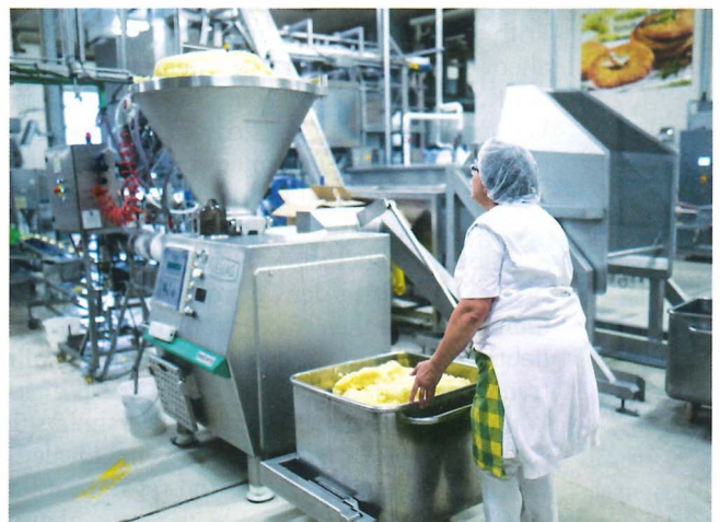
Frisch zubereiteten Kartoffelbrei geben die Mitarbeiterinnen in einen Trichter. Auf der gegenüberliegenden Seite der Maschine entstehen daraus runde Klöße.
